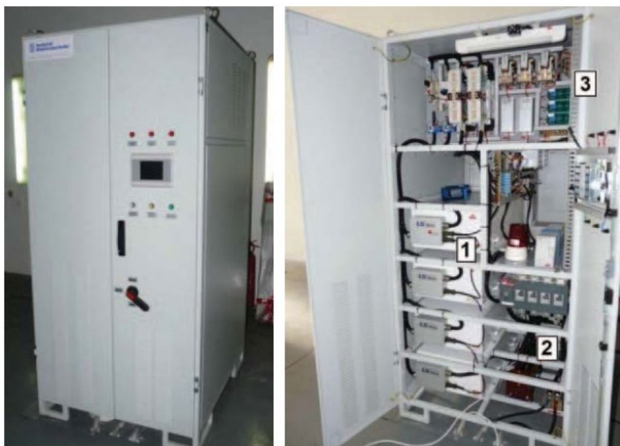
Рисунок 12. Експериментальний блок суперконденсаторів. 1 – суперконденсатори сумарною ємністю 0,7 кВт·год, 2 – DC/DC перетворювач потужністю 150 кВт, 3 – пристрій захисту та фільтри.
